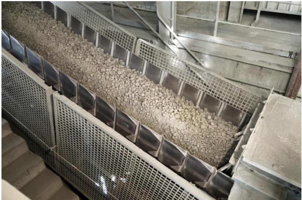
Beispiel: AUMUND-Plattenband Typ KZB für den Transport von Klinker (Foto AUMUND)
