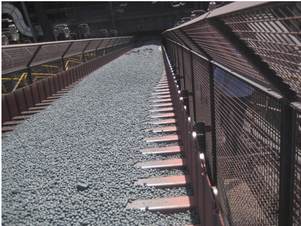
Beispiel für einen AUMUND-Pellet Förderer Typ KZB (Foto AUMUND)
