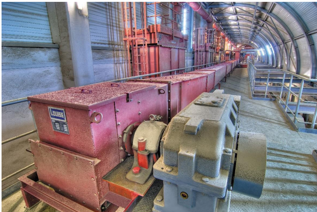
Beispiel für den Einsatz eines AUMUND-Trogkettenförderers Typ LOUISE in einem Zementwerk (Foto AUMUND)
